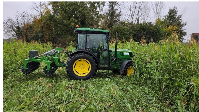
Foto 2 Crimproller voor het kneuzen van de groenbedekkers, ontwikkeld door pcfruit vzw.
