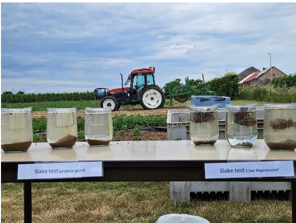
Figuur 2: Resultaat van een aggregaatstabiliteitstest waarbij bodem in een netje ondergedompeld wordt in water. De bodem bij de regeneratieve teelt (rechts) behoudt duidelijk zijn structuur.
