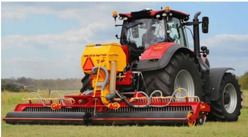
Figuur 6: Vredo Agri Twin doorzaaimachine. Deze machine kan gebruikt worden om gras in de maïsstoppel te zaaien en zo de bodem zo min mogelijk te bewerken, waardoor de mineralisatie in het najaar niet op gang komt door de bodembewerking. (Bron: Vredo)
