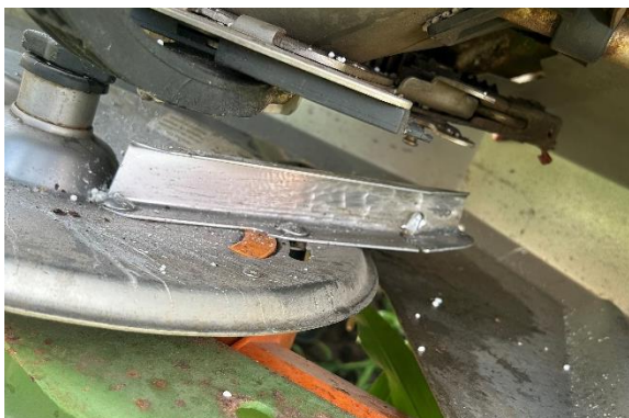
Foto 2. Een gat in de schoepen waar een plaatje op werd gelast. Ook bij zwaardere slijtage is al vervanging nodig.
