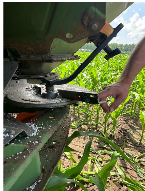
Foto 1. Gaten in de schoepen worden best hersteld
