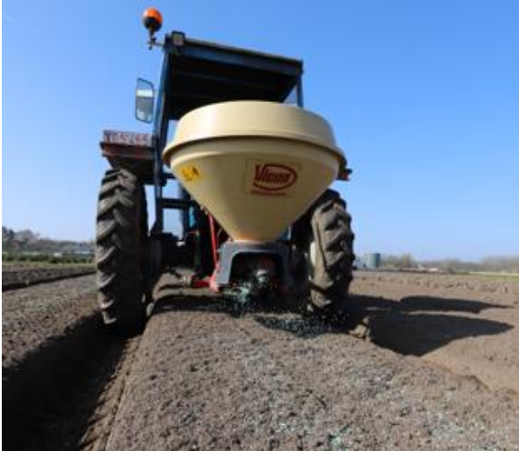
Figuur 3: Door de meststofstrooier correct in te stellen, wordt alleen het oppervlak van het gewent bemest. Bemesting van de rijsporen wordt zo vermeden.
