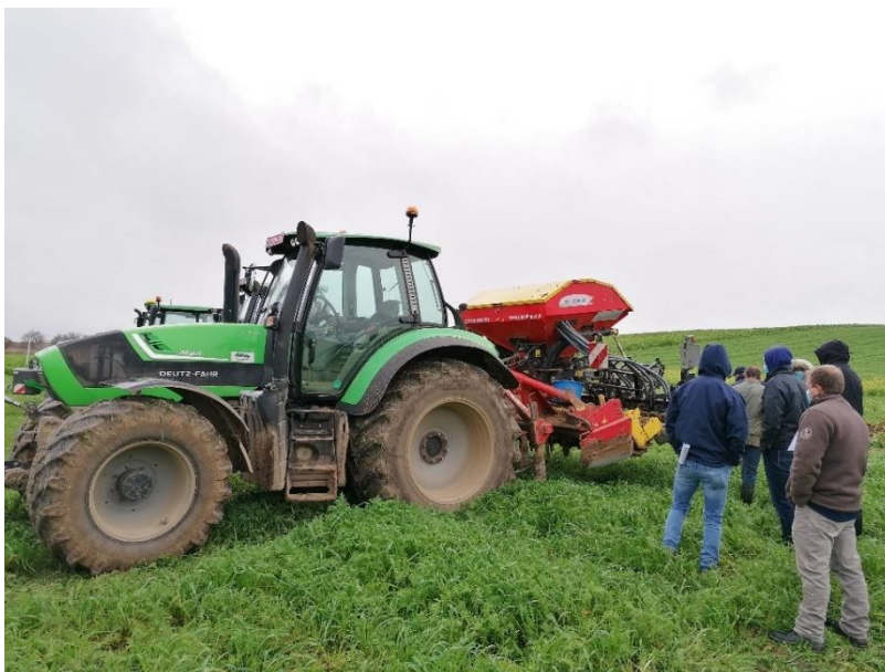
Figuur 2: Totale combinatie Agrignia, rotorkoepel, zaaimachine
