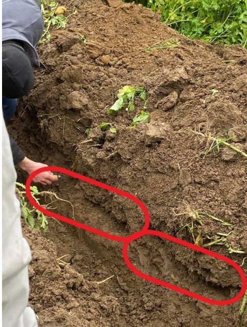
Figuur 3 Beeld waarbij duidelijk de inwerking van de brede ganzevoet van de Kuhn DC 301 zichtbaar zijn
